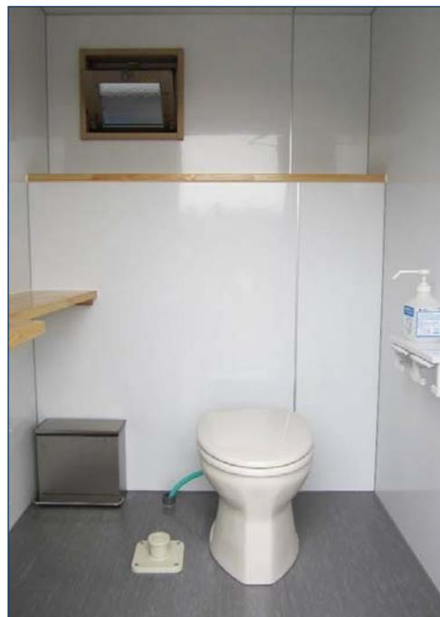
『せせらぎ』スピリッツ・ネオは、快適な室内空間や室内寸法、装備品などを満足するだけでなく、高い防臭効果と一般の水洗トイレと同等の快適なトイレユニットです。床下の給水槽より足踏みポンプにて便器へ給水し、水洗洗浄し、床下汚水槽に貯留します。電源を必要としないトイレユニットで、どんな場所でも快適に利用できます。
